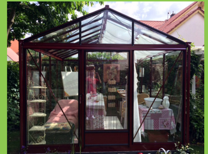
Dach 16 mm Stegdreifachplatte Seitenwände 14 mm Isolierglas
