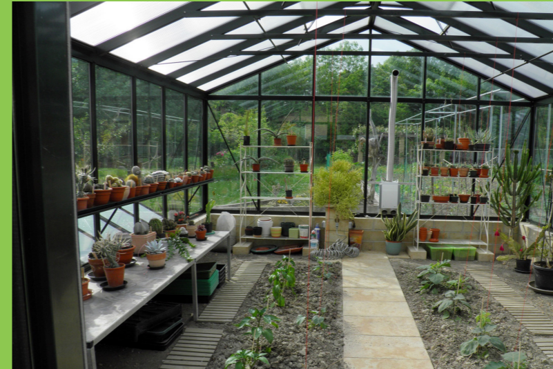
Dach 16 mm Stegdreifachplatte Seitenwände 14 mm Isolierglas
