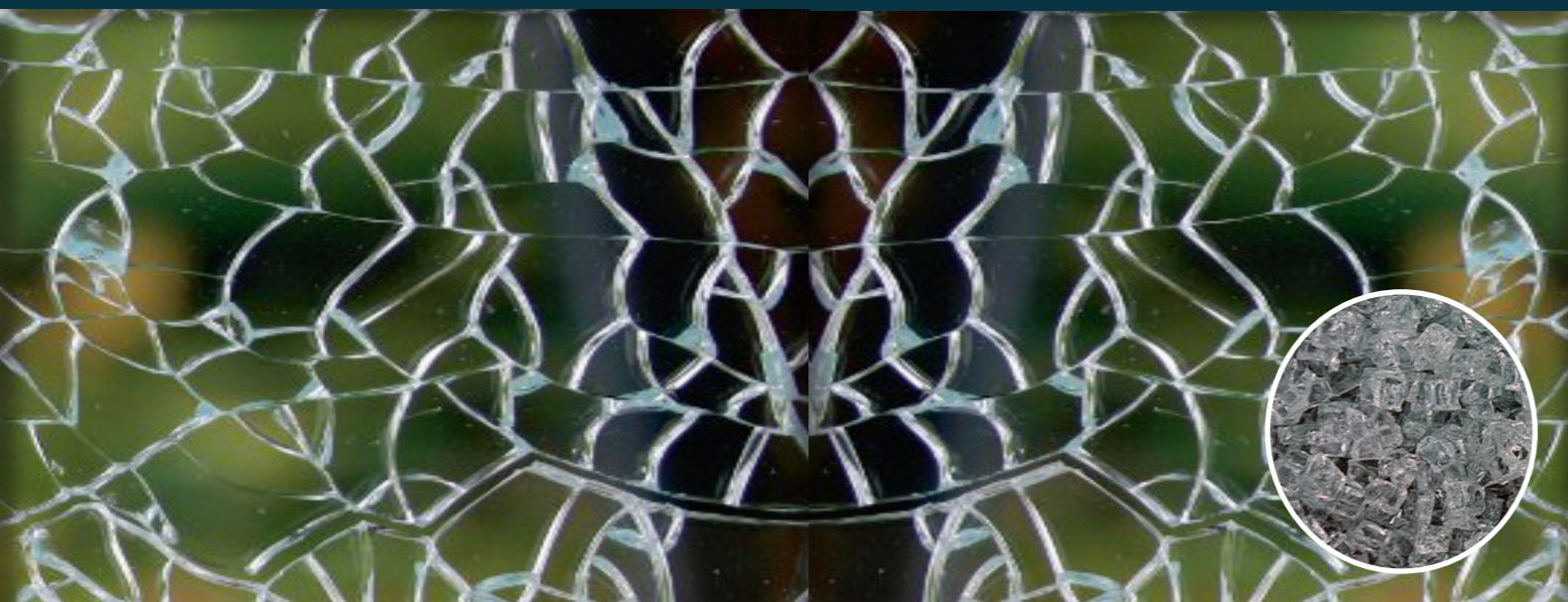
Splitterbild ESG Zerfall in unscharfkantige Kleinsplitter
