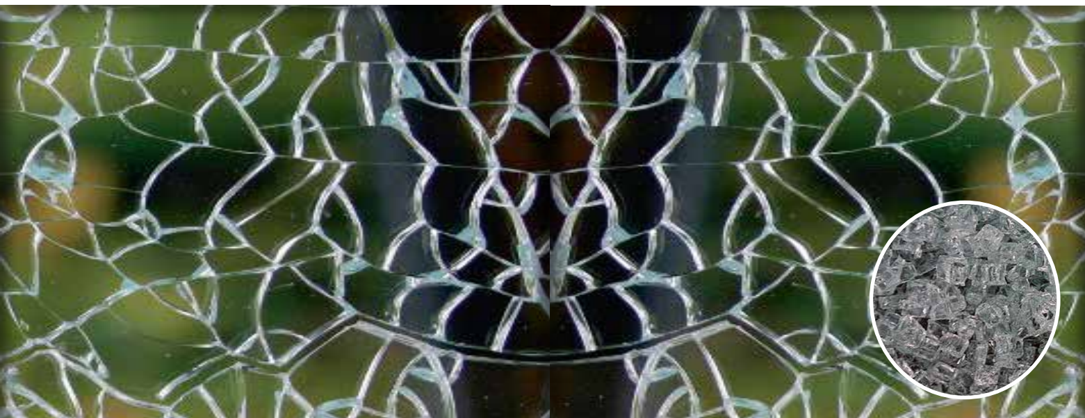
Splitterbild ESG Zerfall in unscharfkantige Kleinsplitter
