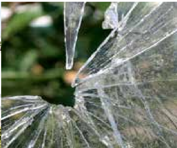
Splitterbild Glas scharfkantiger Bruch hohes Verletzungsrisiko
